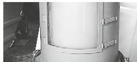
Wartungstüre für Reinigungsarbeiten
