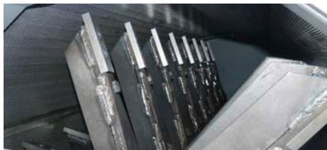
Rotor mit austauschbaren, verschleißbaren Platten
