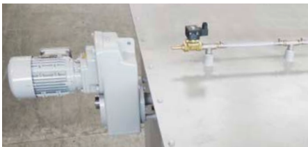
Abreinigungssystem für die Sieboberfläche mit Einspritzdüsen
