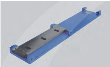
Die Justierung aller Messer erfolgt außerhalb der Schneidmühle in einer Einstelllehre, die zum Lieferumfang gehört. Dadurch entfallen lästige Einstellarbeiten innerhalb der Maschine.
