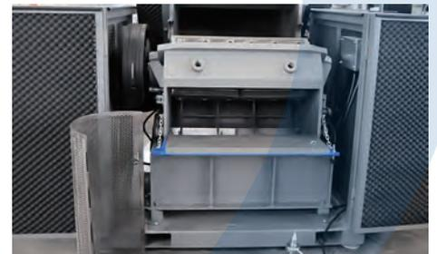
Das benutzerfreundliche Design der GSC-Baureihe ermöglicht eine schnelle und einfache Zugänglichkeit für Wartungs-/Reinigungsarbeiten, Messer- und Siebwechsel.
