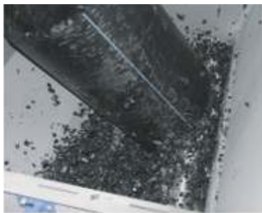
Rohrzerkleinerung, Vorzerkleinerung der Rohre für die zweistufige Zerkleinerung mit einer Schneidmühle
